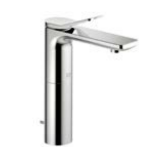
33 506 845 Single-lever basin mixer with raised base with pop-up waste Смеситель для умывальника однорычажный с удлиненной ножкой со сливным гарнитуром Bateria umywalkowa podwyższana z korkiem automatycznym [5,7 l/min.]
