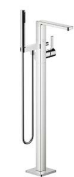
25 863 710 Single-lever bath mixer with stand pipe for free-standing assembly with hand shower set Смеситель для ванны однорычажный с вертикальной трубой для свободностоящего монтажа с комплектом с душевым шлангом Bateria wannowa wolnostojąca do montażu wolnostojącego z zestawem prysznicowym [26,7 l/min.]
